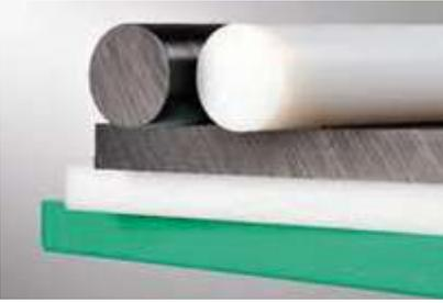
Se define como polietileno cuyo peso molecular es 3,1 millones o más. UHMW es un termoplástico semicristalino básico resistente, resbaladizo y muy resistente a la abrasión que también es resistente a los productos químicos y a la corrosión. La resistencia al impacto es tan alta que el UHMW PE no se rompe con el impacto, está disponible en placa, barra, tubo, cinta, perfiles personalizados, piezas moldeadas y mecanizadas.
